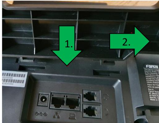
2. Collegare il cavo del ricevitore al jack del ricevitore (L'estremità lunga del cavo al telefono)
